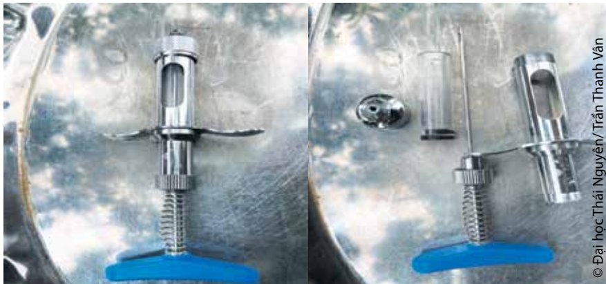
Hình 51. Bơm tiêm tự động chủng đậu gà
